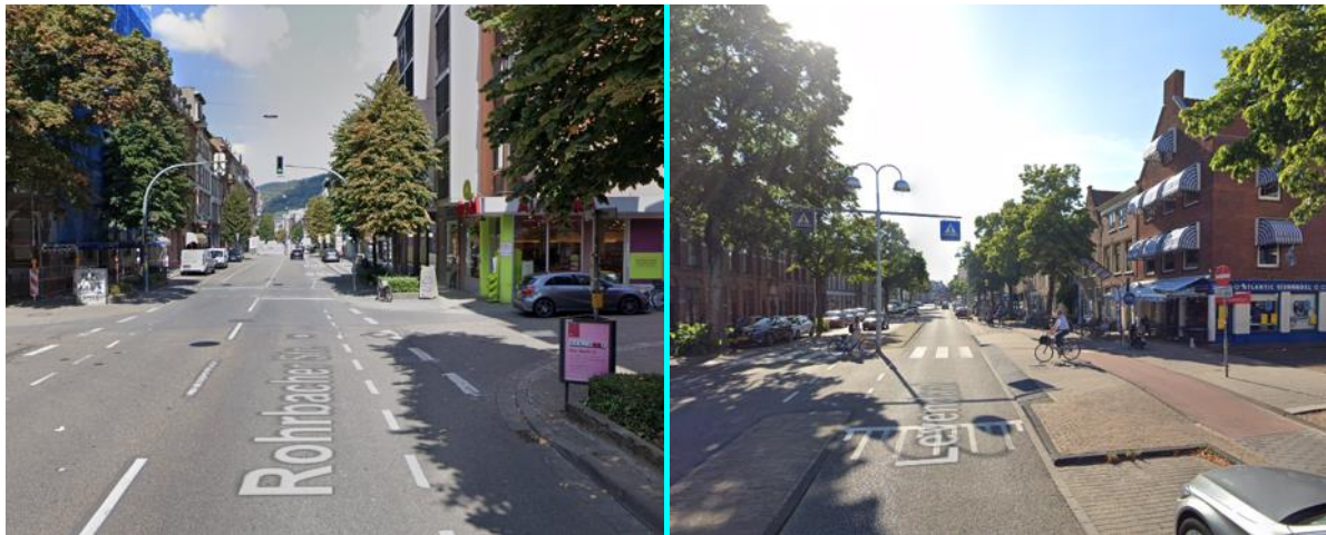
Abbildung 50. Beispiel von Radinfrastruktur die umgesetzt ist mittels Markierung (links) und mittels Aufpflasterung (rechts) – Beispiel aus Leiden, Niederlande (Quelle: Google)
